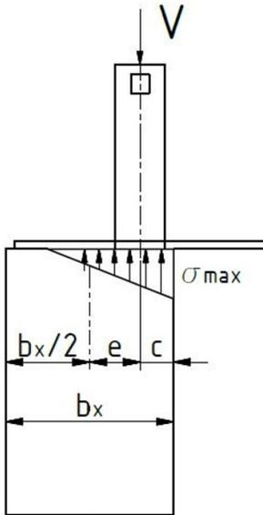
$$\frac{b_x}{6} < e_x \leq \frac{b_x}{3} \quad / \quad \sigma_{max} = \frac{2 \cdot V}{3 \cdot c \cdot b_y} \quad \sigma_{min} = 0!$$
